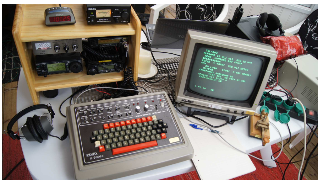
RTTY-station bestående av TONO kommunikationsdator, PHILIPS monitor, ICOM 706, MFJ antennavstämning och nätaggregat. Vidare syns ICOM 3230 VHF/UHF FM-rigg och AnyTone 588 VHF FM-rigg, CW-nyckel, hörlurar och klocka.
