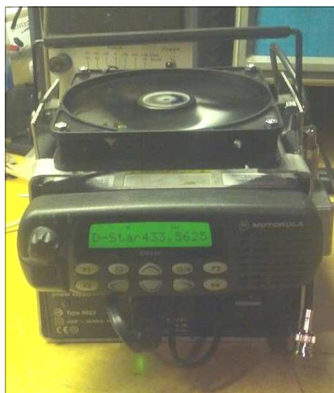
SK6BA's hotspot består av Motorola mobilrigg, Raspberry PI dator, modem, kylfläkt och nätaggregat. Foto: Anders/WGG
